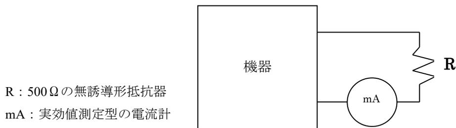
附属書図 AA.1 出力電流測定回路
